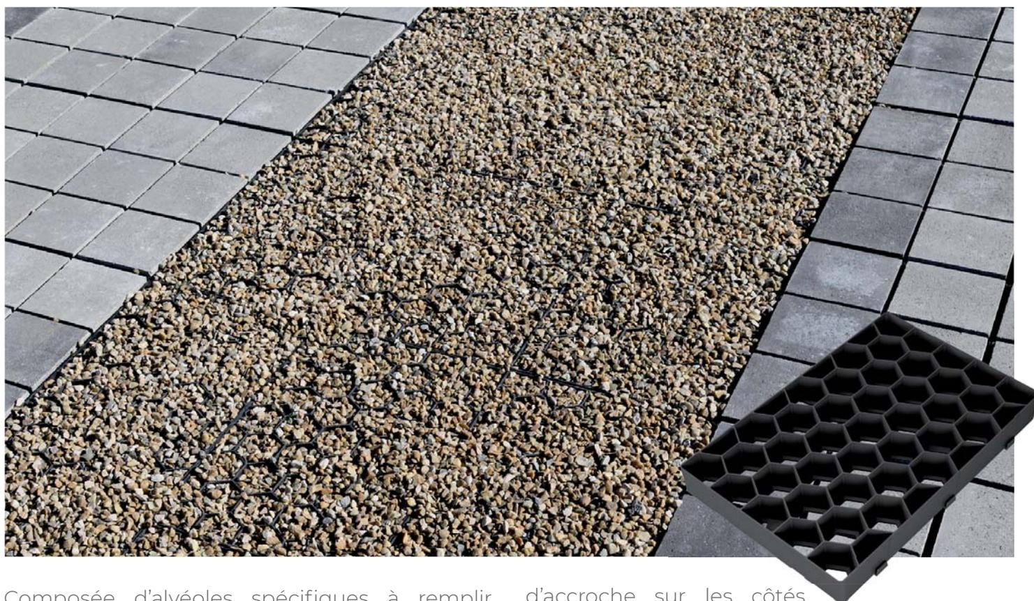
Composée d'alvéoles spécifiques à remplir avec des graviers concassés de granulométrie comprise entre 5 et 16 mm, la plaque stabilisatrice pour graviers URBANIT® JOUPLAST® permet la mise en œuvre d'un revêtement drainant et carrossable ne générant ni flaques, ni ruissellement, ni ornières.
